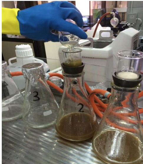
Figure. 17. 18. 19. 20 et 21 Incubation des bouteilles après 24h ouverture et filtration
