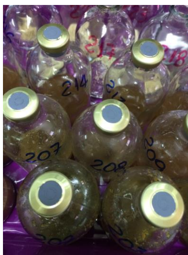
Figure. 14. 15. 16. Remplissage des bouteilles contenant des aliments par le jus de rumen et la salive artificielle et fermeture des bouteilles
