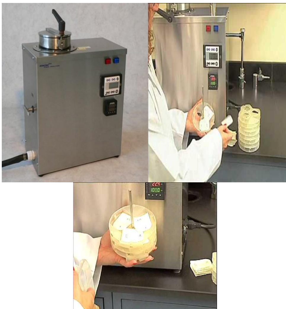
Figure. 6.7.8. Fibertech Ankom avec les sacs contenant l'aliment à analyser
