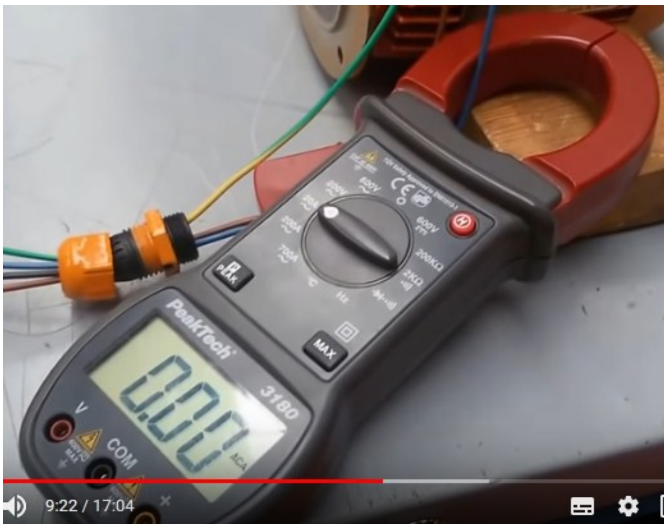
Pince ampèremétrique entourant le câble d'une des phase du moteur (à gauche le bouton PEAK)
