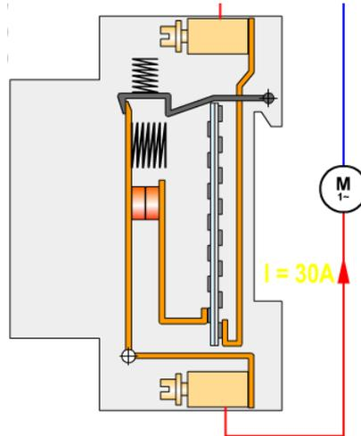
Le circuit étant ouvert, le bilame va refroidir et reprendre sa position d'origine.
