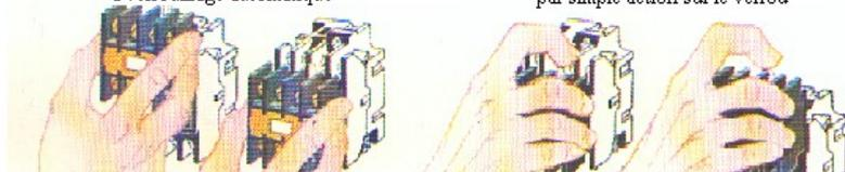
**Montage de contacts auxiliaires sur contacteur série D (Télémeccanica)**
