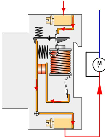
La bobine électromagnétique, sous l'effet de l'élévation de l'intensité du courant va instantanément attirer le levier et provoquer l'ouverture rapide (10 à 20ms) du disjoncteur. Cette réaction s'obtient à partir d'un seuil de courant variant de 3 à 14 fois le calibre selon le disjoncteur : le seuil magnétique  $I_m$ .
