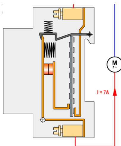
Animation disjoncteur magnétothermique : dispositif thermique (source : guide des métiers électrotechnique)
