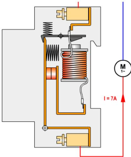
Supposons maintenant que le fil de phase vienne à toucher le fil de neutre en raison d'un défaut d'isolement.
