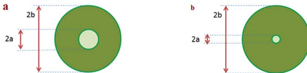
Figure 6 : Dimensions de fibres optiques multimodale (a) et monomode (b).
