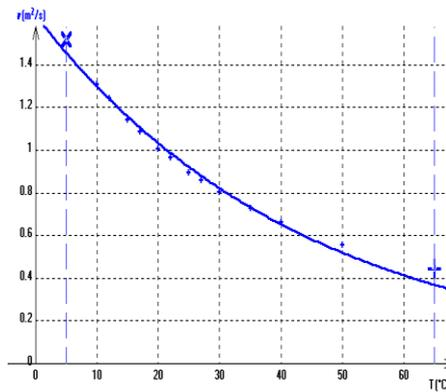
Variation de la viscosité de l'eau en fonction de la température
