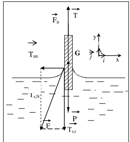
Fig.2 - Exemple d'une tige immergée
