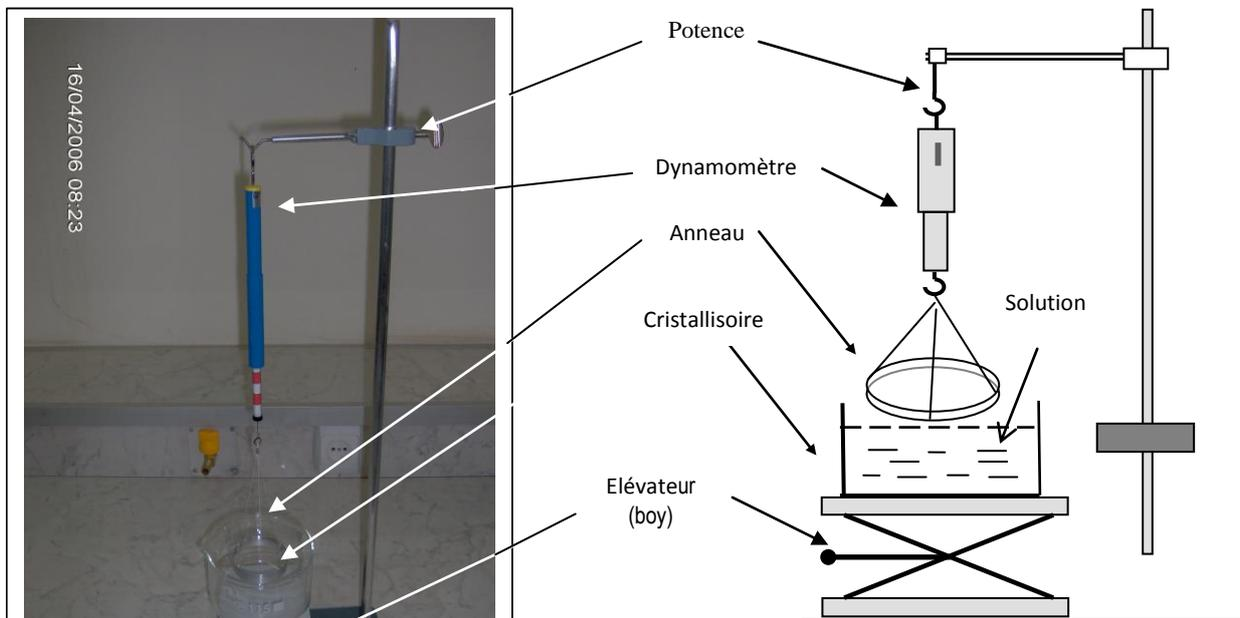
Fig.6 bis – Schéma de principe de la méthode
