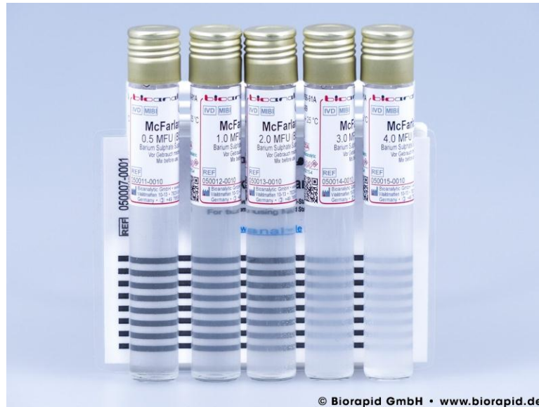
Figure 3 : les standard McFarland servent de standards de turbidité pour préparer les suspensions de microorganismes.
