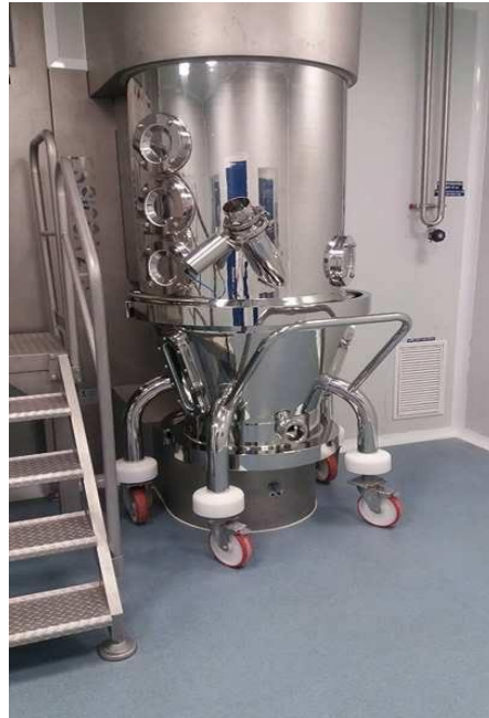
Figure 16: lit d'air de séchage
