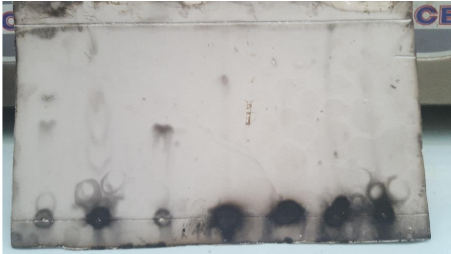
Figure 28 : révélation par acide sulfurique et éthanol
