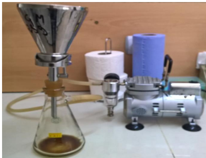
Figure 42 : Filtration sous vide du macérât.
