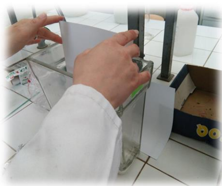
Figure 18: Emplacement de la plaque CCM dans la cuve
