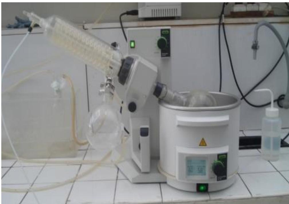
**Figure 19.**Evaporateur rotatif
