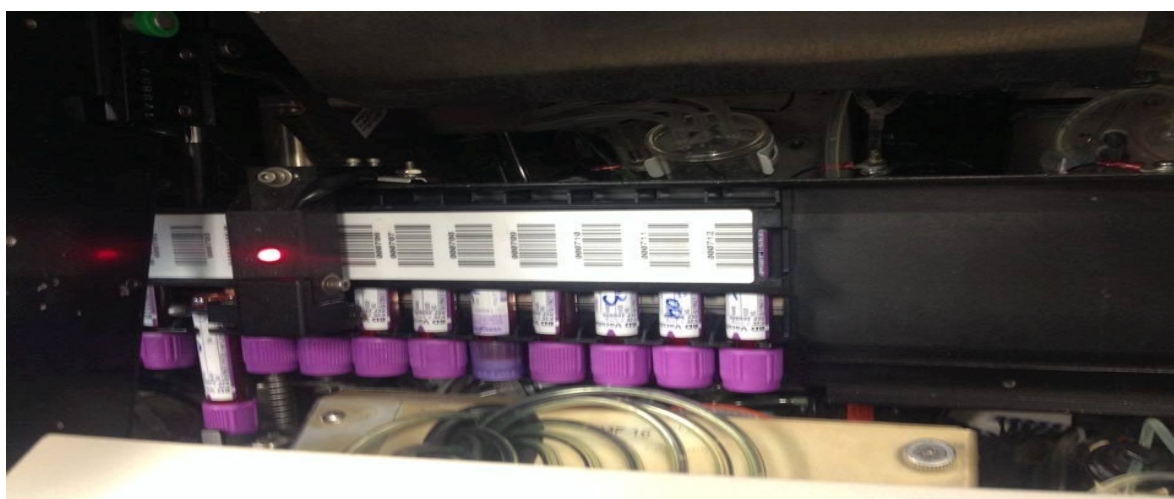
Photo 02 : Le passeur d'échantillons intégré de l'automate.
