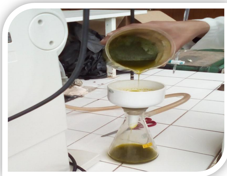
Figure 24 : Filtration de macérât sous vide. (Photo originale)
