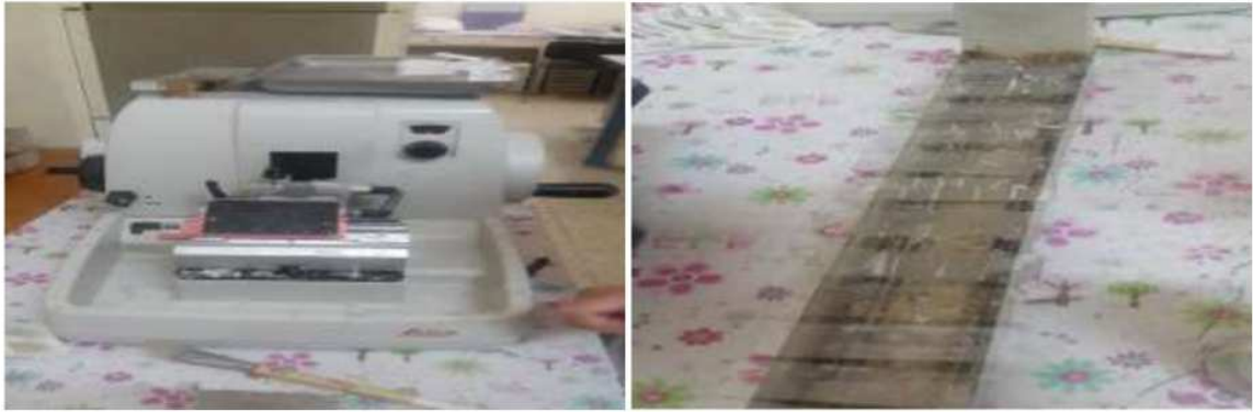
Figure 19 : réalisation d'une Coupe et l'étalement sur la lame
