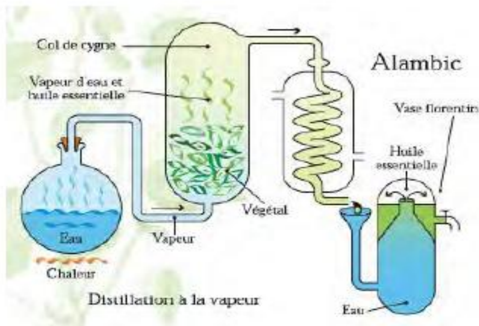
Figure 6 : Schéma d'un montage de distillation par entraînement à la vapeur d'eau (Cazau-Beyret, 2013).
