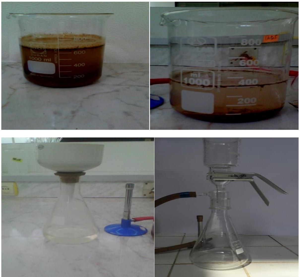
**Figure 11** : Les étapes de préparation de l'échantillon avec la filtration par le système de filtration. (Wheaton. USA)
