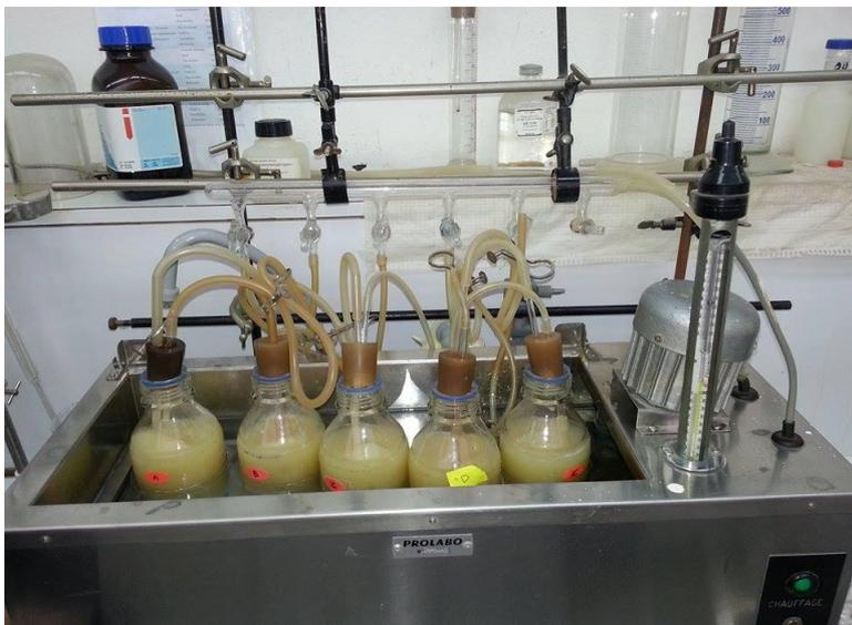
Figure : 7- Les cinq milieux inoculés avec le liquide ruminal filtré, sous flux de CO<sub>2</sub>
