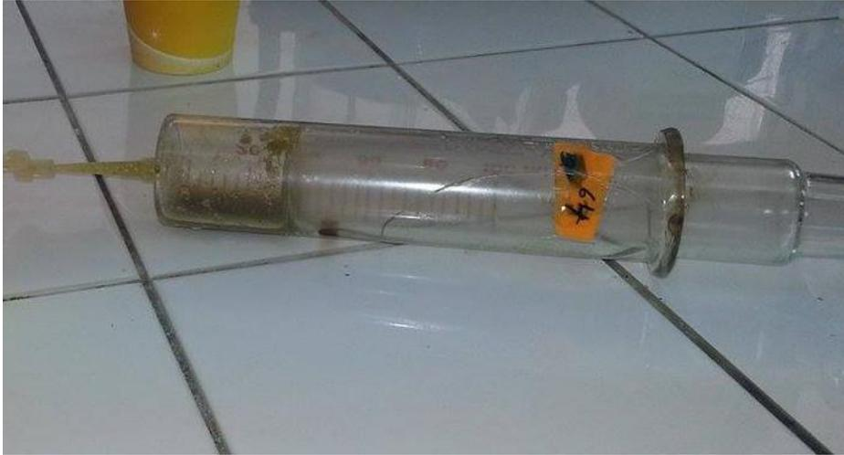
Figure : 8- Seringue contenant le mélange : milieu, substrat et liquide ruminal filtré
