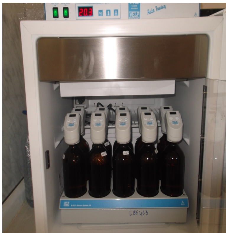
Figure 3: Un appareil manométrique de type VELP SCIENTIFICA pour la mesure de la DBO
