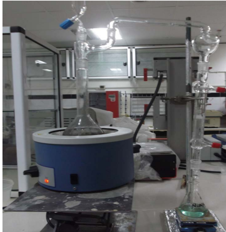
Figure 4 : Photo du distillateur de l'azote ammoniacal
