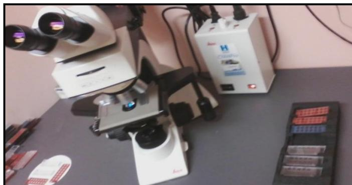
**Figure 48: analyse des lames par microscope à fluorescence.**
