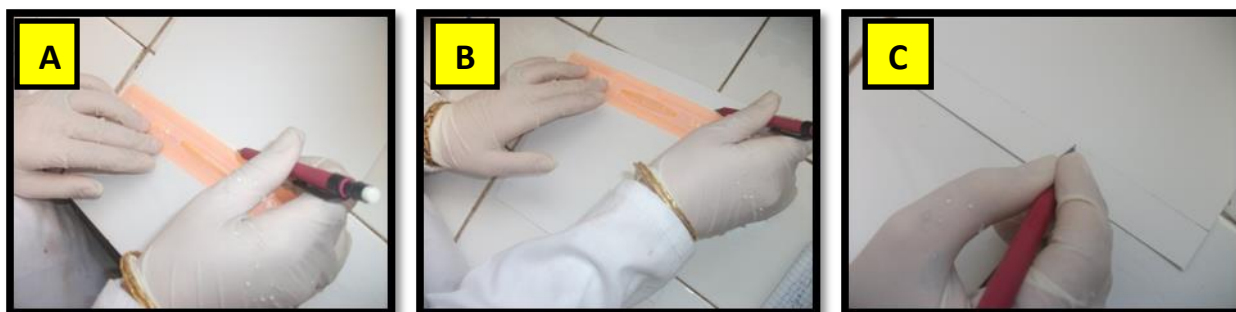
Figure.41 : Les étapes de la préparation de plaque CCM
