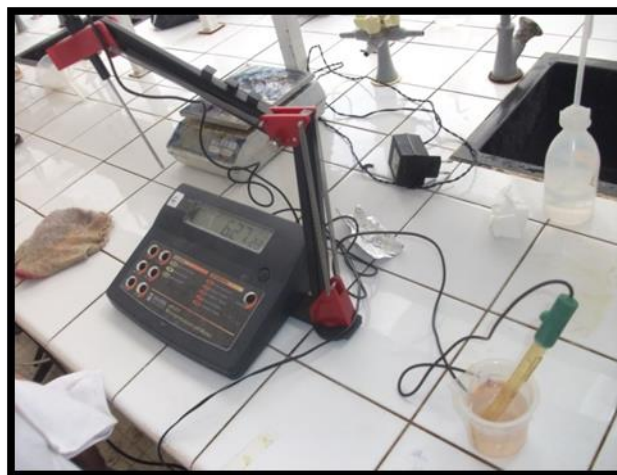
Figure.51 : La détermination du PH par l'appareil du PH mètre
