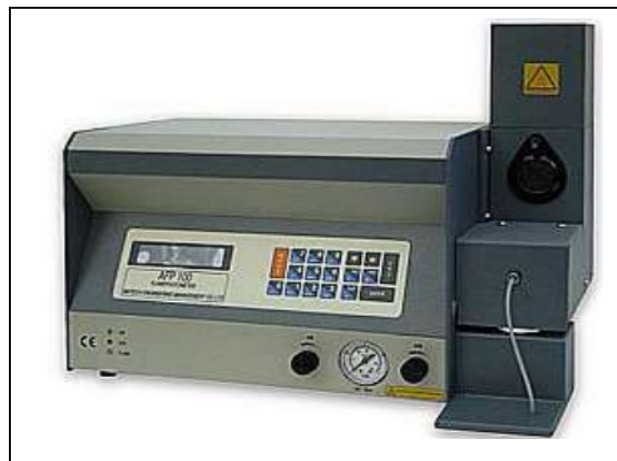
Figure 33: Photométrie à flamme
