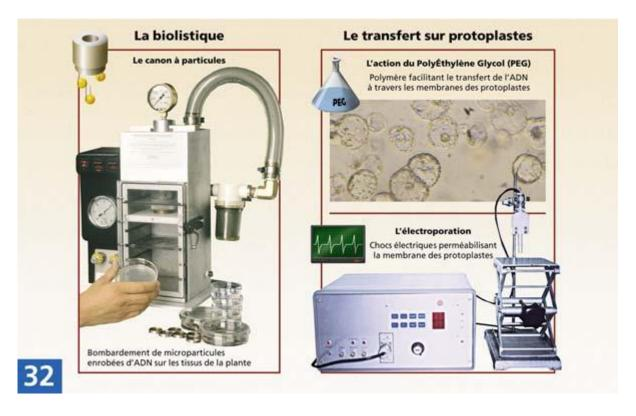
Des méthodes dites de transfert direct utilisent des moyens physiques ou chimiques pour permettre la pénétration d'ADN, généralement sous forme de plasmides dans une cellule végétale. Les plus utilisées sont la biolistique et le transfert sur protoplastes.
