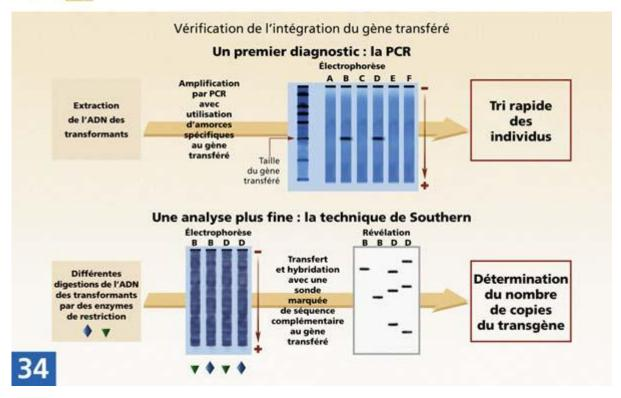
Lorsque l'on transforme génétiquement une plante, il est important de déterminer rapidement si l'ADN transféré est intégré dans le patrimoine génétique de la plante. En effet, la sélection des cellules sur un milieu contenant l'agent de sélection n'est pas suffisamment fiable. Certaines cellules, bien que non transformées, parviennent quand même à se développer sur le milieu de sélection.
