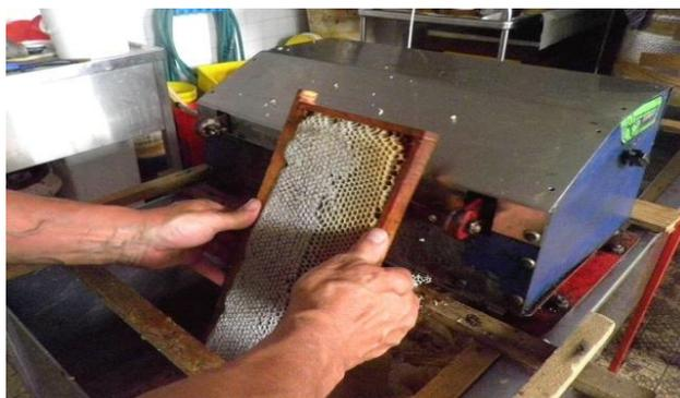
Machine à lames vibrantes doubles permettant de désoperculer les deux côtés des cadres à la fois (figure 3).
