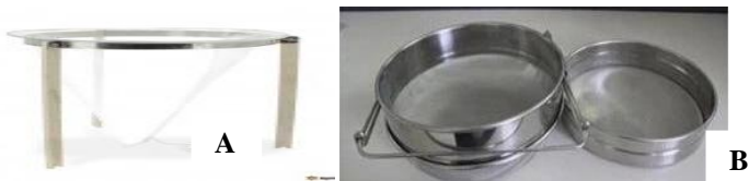
Figure 21 : A / Filtre conique en nylon; B/ Filtre tamis en inox. Figure 22 : Passoire à double tamis à la sortie de l'extracteur. (Guerrirat, 2017).
