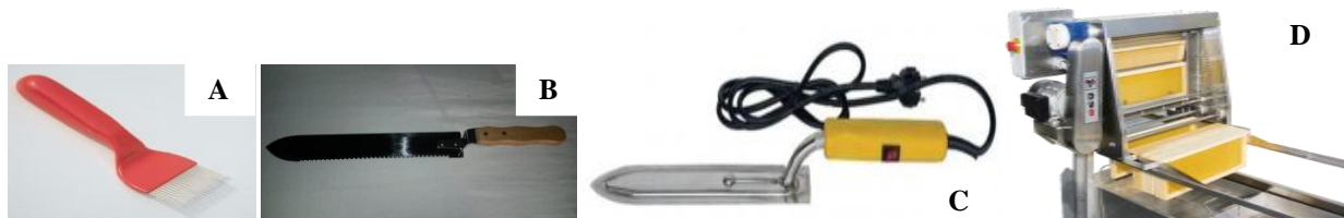
Figure 15 : A/ Fourchette à désoperculer; B/ Couteau à désoperculer manuel; C/ Couteau à désoperculer électrique; D/ Machine à désoperculer électrique.
