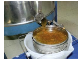
Figure 21 : A / Filtre conique en nylon; B/ Filtre tamis en inox. Figure 22 : Passoire à double tamis à la sortie de l'extracteur. (Guerrirat, 2017).
