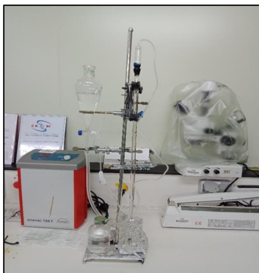
Figure 16 : Système de déplacement de l'eau pour la mesure du biogaz produit par les différentes souches
