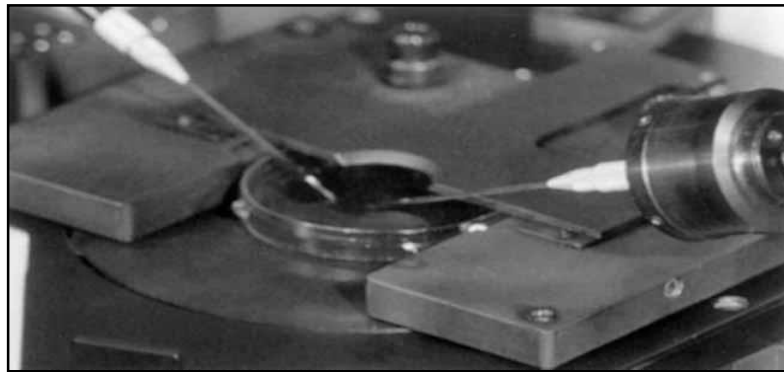
Annexe. 02 : Vue supérieure proche d'une partie de microscope montrant la plaque métallique électriquement chauffée sur laquelle la boîte contenant les gamètes est placée.
