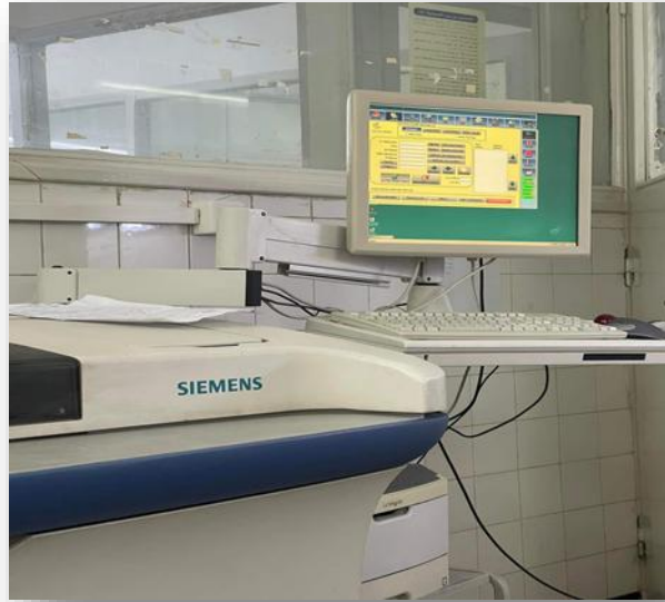
Figure.11 : appareil utilisée pour le dosage des hormones thyroïdiennes « Siemens immulite ».
