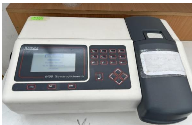
Figure13. Spectrophotomètre utilisé pour la mesure des différents marqueurs biochimiques.
