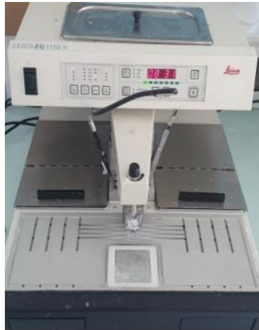
Leica EG 1150 H : Station d'inclusion de tissus en paraffine
