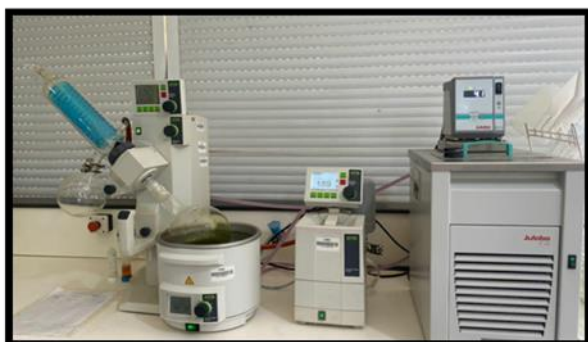
5. Evaporation de l'extrait méthanolique à l'aide d'un évaporateur rotatif.
