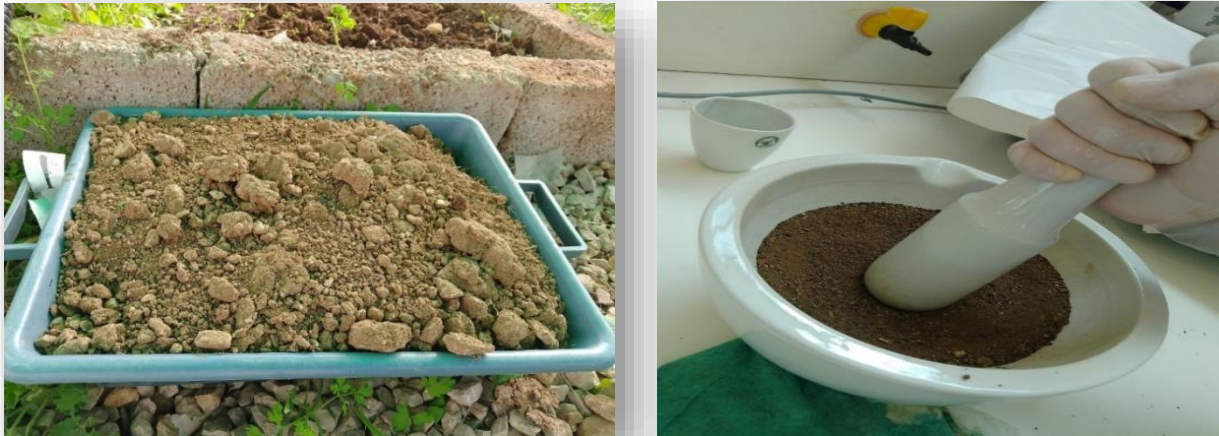
Figure 02 : Préparation de sol
