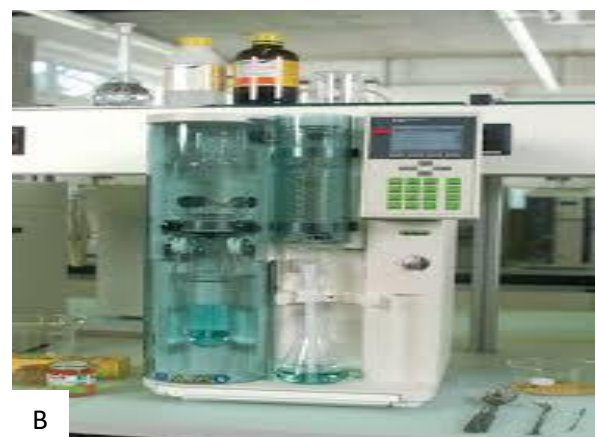
Figure II.4. Appareil de kjeldahl (A : dispositif minéralisateur, B : dispositif distillateur.)
