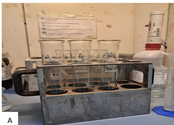
Figure II.4. Appareil de kjeldahl (A : dispositif minéralisateur, B : dispositif distillateur.)
