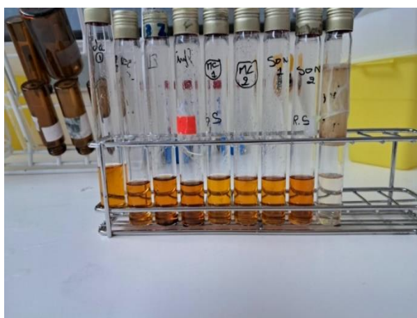
Figure II.9. Tubes contenant les complexes colorés résultants de la condensation des dérivées fulfuriques avec le phénol
