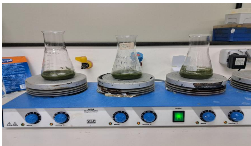
Figure II.7. Extraction par infusion sur plaques chauffantes (VELP SCIENTIFICA)
