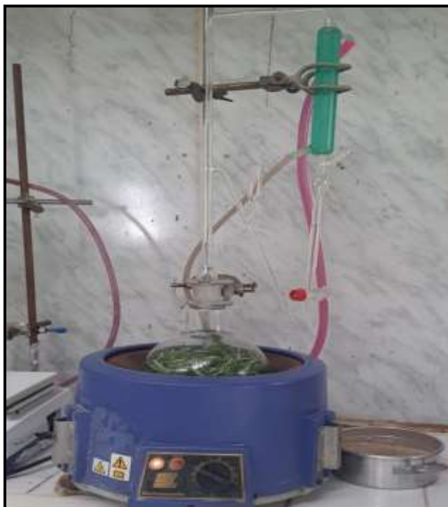
Figure 9 : Montage de l'hydrodistillation employé pour l'extraction de l'huile.
