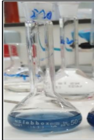
Figure 18: Mélange réactionnel servi à la détermination de la teneur en orthophosphates.
