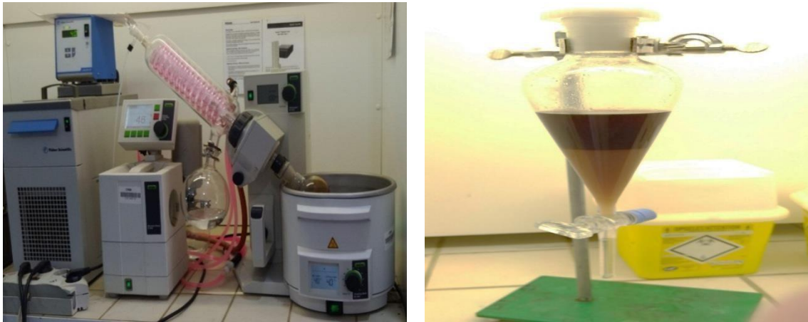
Figure 14: Etapes du dosage de la matière grasses : A : Rotavapor ; B : Ampoule à décanter avec le mélange margine-alcools.
