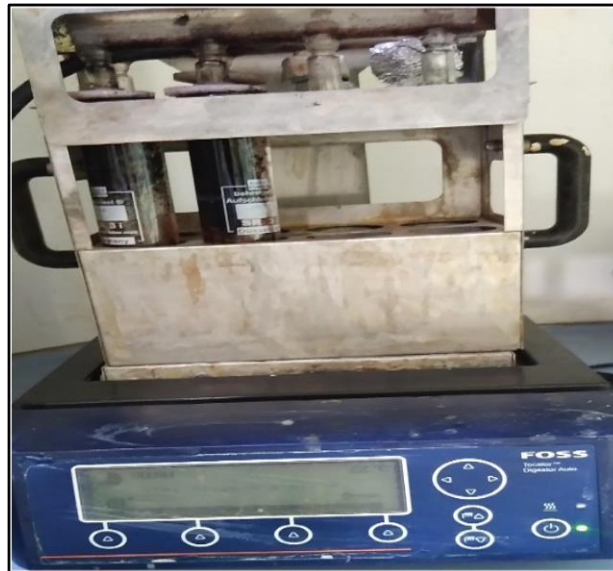
Figure 15: Unité de minéralisation contenant les fioles Kjeldahl ( Kjeltec 2400 Foss ).
