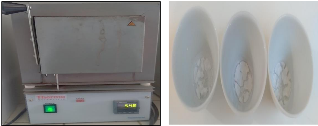
Figure 13: A : Four à moufle ; B : Creusets contenant les cendres (MM).
