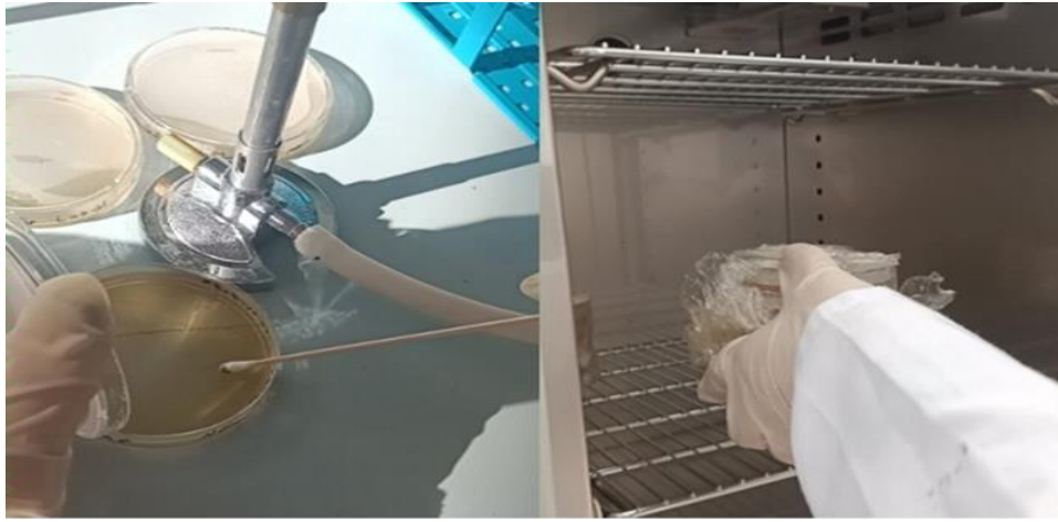
Figure 18 : (a) : Isolement des moisissures sur milieu PDA, (b) : incubation à 30°C pendant 5-7 jours.
