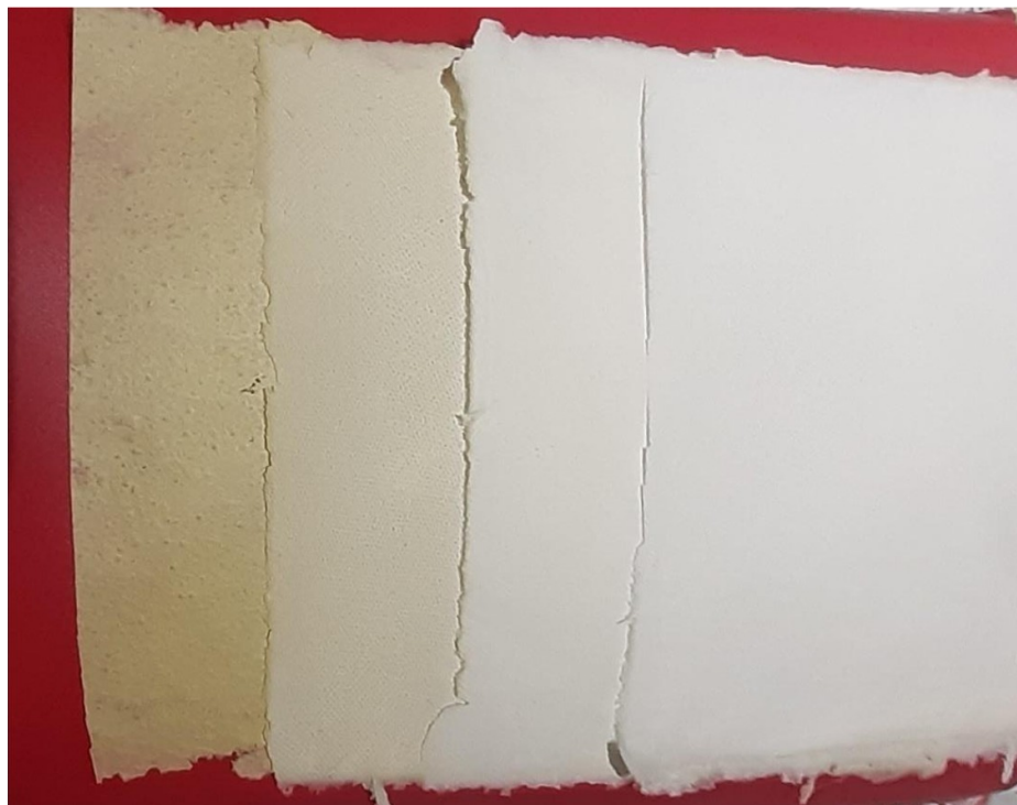
Figure 14 : Papier kraft marron 60 gr/ papier kraft 105 gr Papier blanc clair 80 gr / papier blanc 100gr
