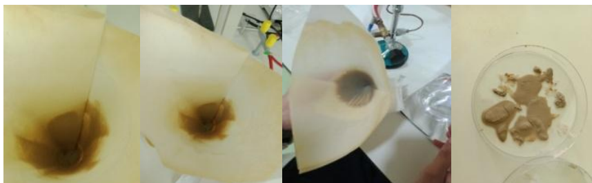
Figure 27 : Biomasse récupérée après filtration du milieu fermenté
