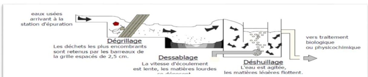
Figure 2: Schéma descriptif des étapes de prétraitement (Degremont, 1995).
