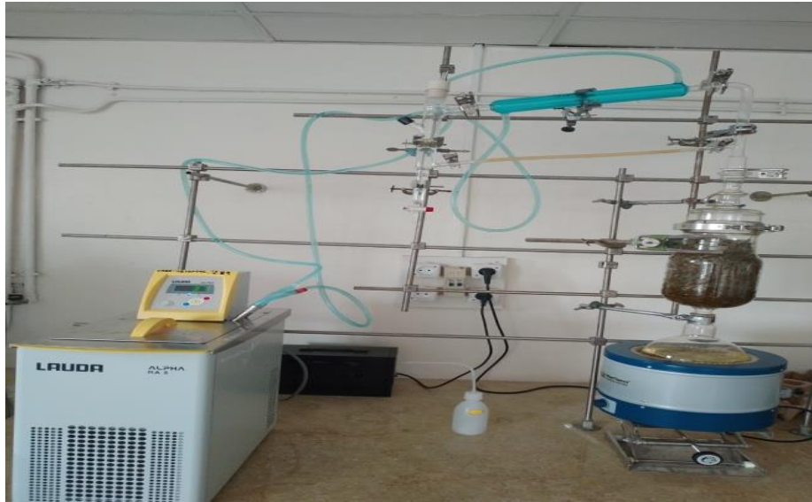
Figure 18 : Dispositif de la distillation par entrainement à la vapeur d'eau (Photo Dr Atmani-Merabet, mars 2022)
