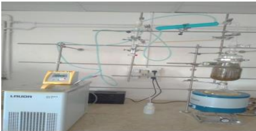
Figure 7 : Montage de l'entraînement à la vapeur d'eau
