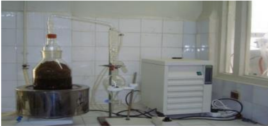
Figure 6 : Montage d'extraction par hydrodistillation
