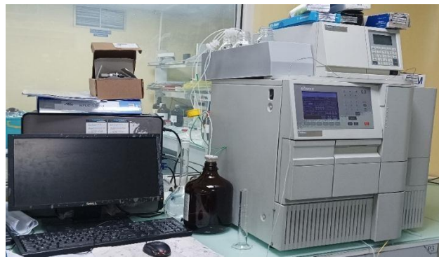
Figure II.3. Les organes d'une chaîne CLHP.
