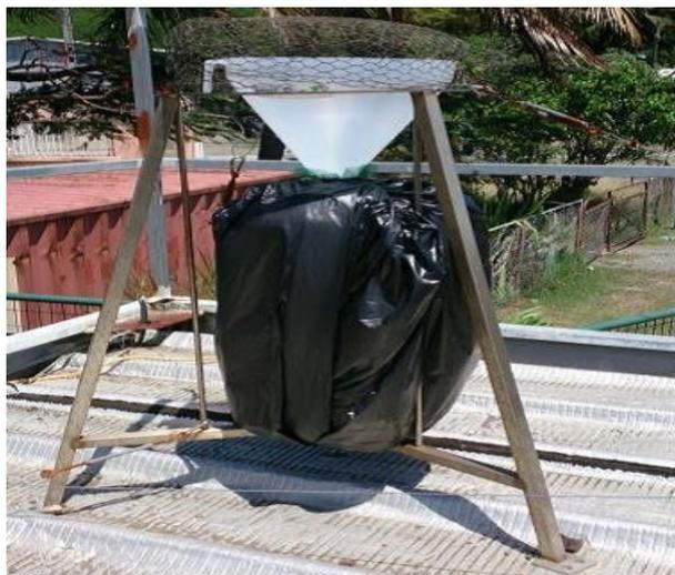
Figure 7 : Jauge Owen installée sur le toit d'une station de mesures (48)
