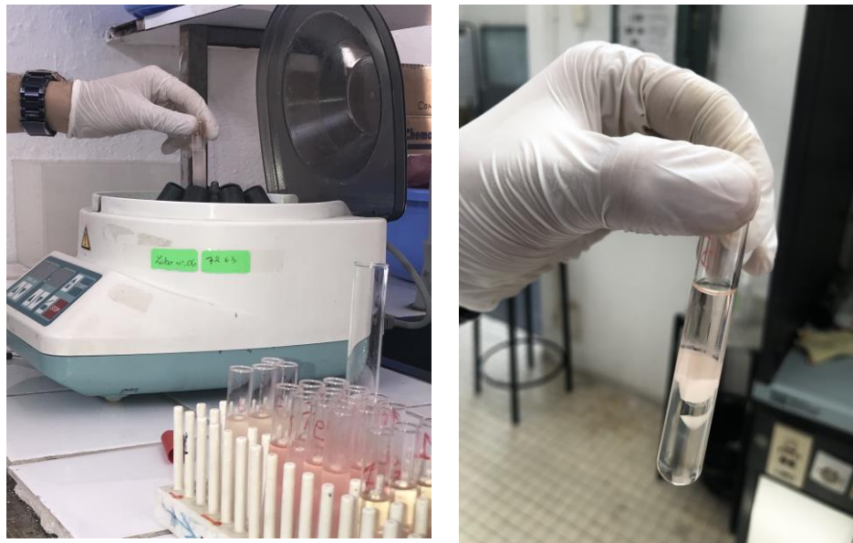
Figure 24 : La formation du complexe coloré en rose lors de dosage du MDA
