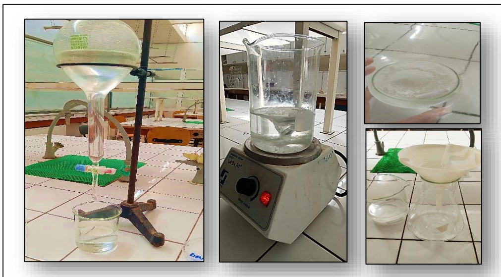
Figure 6 : Phase organique recueillie après décantation (photos originaux)
