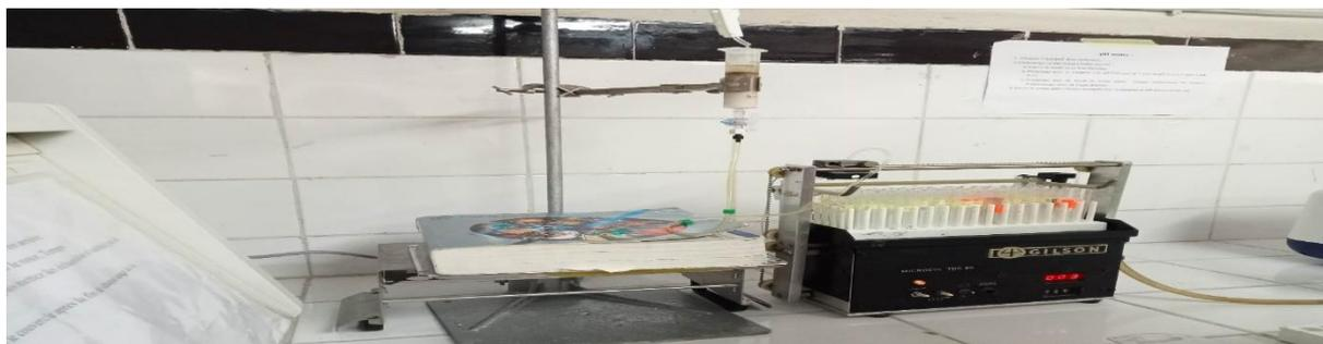
**Figure 17:** Collection des fractions purifiées par le collecteur de fractions GILSON FC80.
