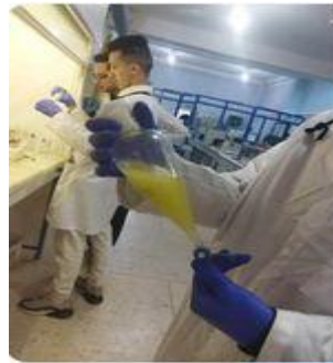
Figure21 : Ampoules à décanter contiennent la solution huile d'olive-Hexane.
