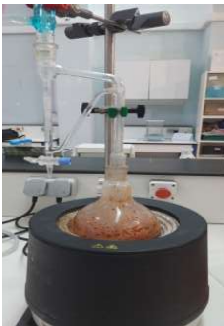
Figure 27. Dispositif d'hydrodistillation (Clevenger)
