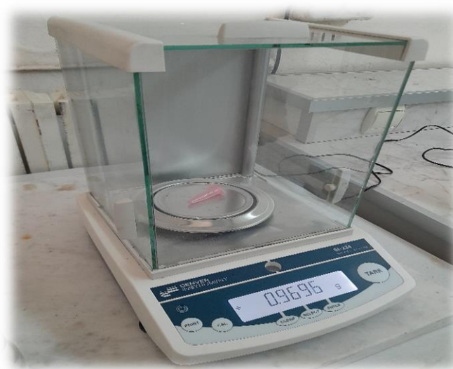
Photo 5 : procédé de détermination de la densité relative de l'huile essentielle du Thymus vulgaris .
