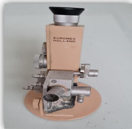
Photo 07 : réfractomètre utilisé pour la mesure de l'indice de réfraction.
