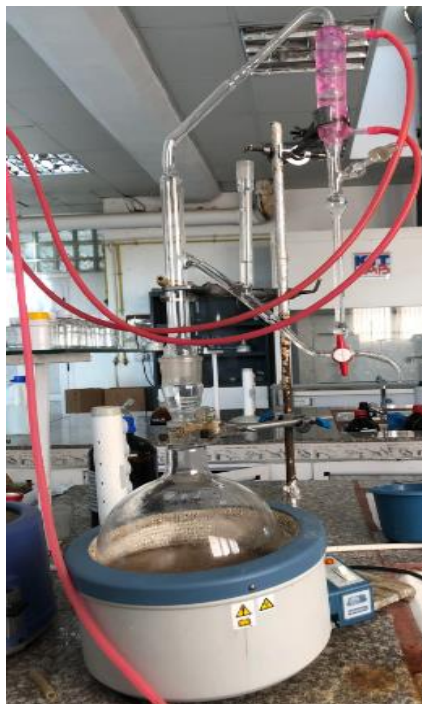
Photo 02 : extraction de l'huile essentielle de clou de girofle par hydrodistillation.
