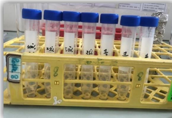
Photo 08 : série de dilution de l'huile essentielle de clou de girofle dans le Tween 80.
