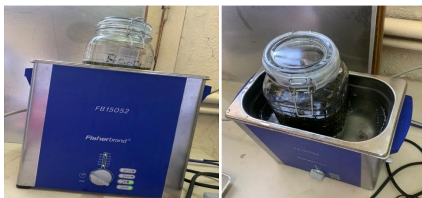
Figure 15 : Extraction dans un bain à ultrasons
