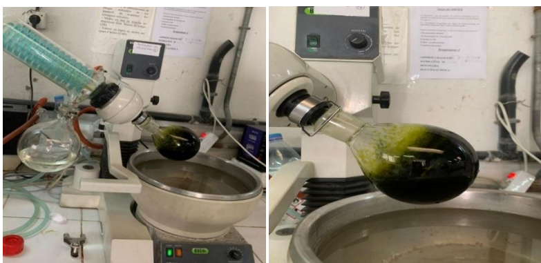
Figure 17 : Évaporation des extraits
