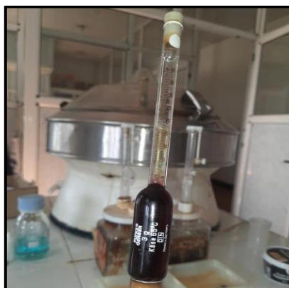
Figure 15 : Le butyromètre Gerber après la centrifugation et alcool iso amylique
